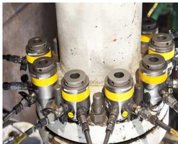
Izq: Ajuste simultáneo del 50% de los espárragos, ajustando cada segundo espárrago del mismo lado – pero de un solo lado.
